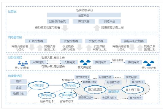
▲图2 面向人工智能的数据通信目标网架构
